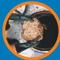
Óleo de cozinha cria crostas endurecidas que causam obstrução na rede de esgoto
