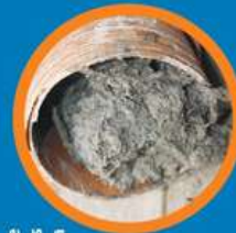
Papel higiênico e fios de cabelo formam bolas sólidas que entopem a rede coletora
