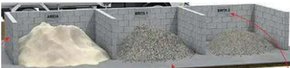
Figura 1 – Separação de materiais por diferença de granulometria
